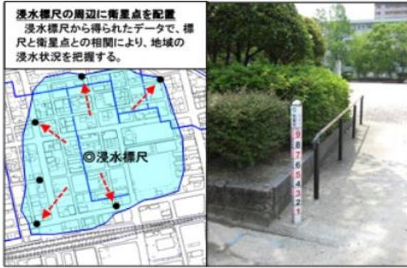
【図3 浸水標尺の設置状況】
